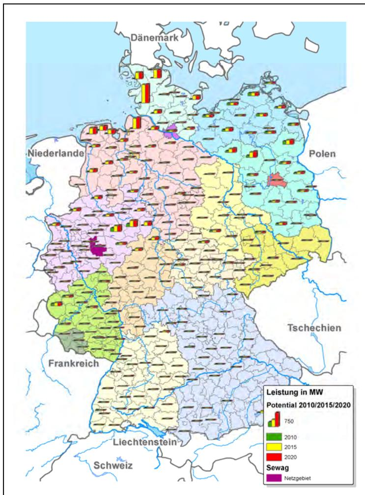
**Abbildung 18** Repowering-Potential in Deutschland unter der Annahme einer 4fachen Leistungssteigerung bei der Verwendung von 3 MW-Anlagen
